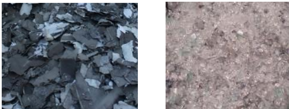
Figure 32 : Fragments de silicium et granules de verre (Source : PV CYCLE, photovoltaïque.info)
