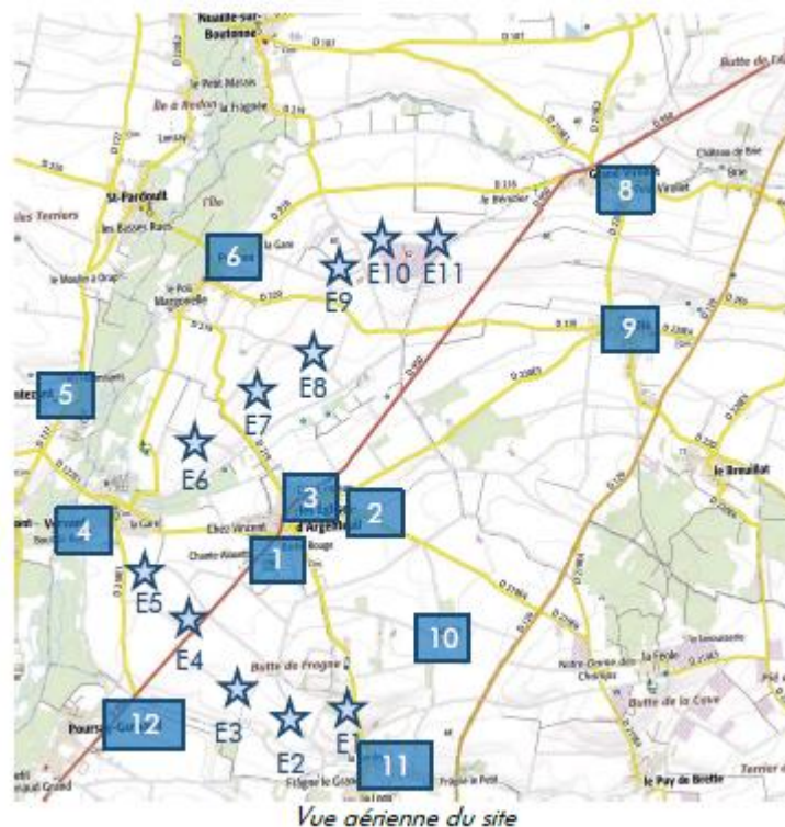
Emplacement des sonomètres lors de l'étude acoustique (p.71 de l'étude acoustique)
