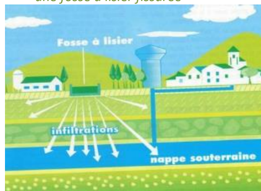
Figure 23. Contamination des eaux souterraines par une fosse à lisier fissurée
