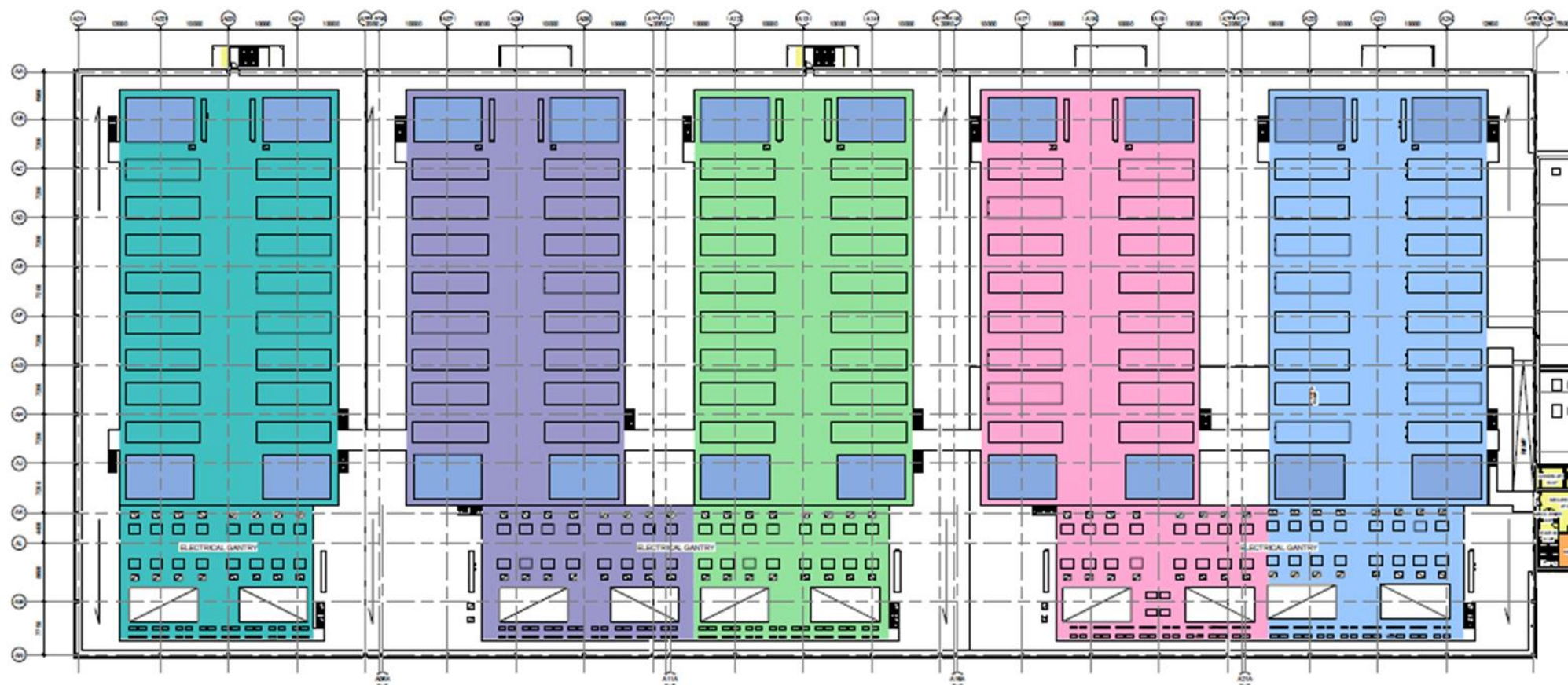
Figure 22 : Localisation des potentiels de danger sur la toiture – Groupes froids DC1
