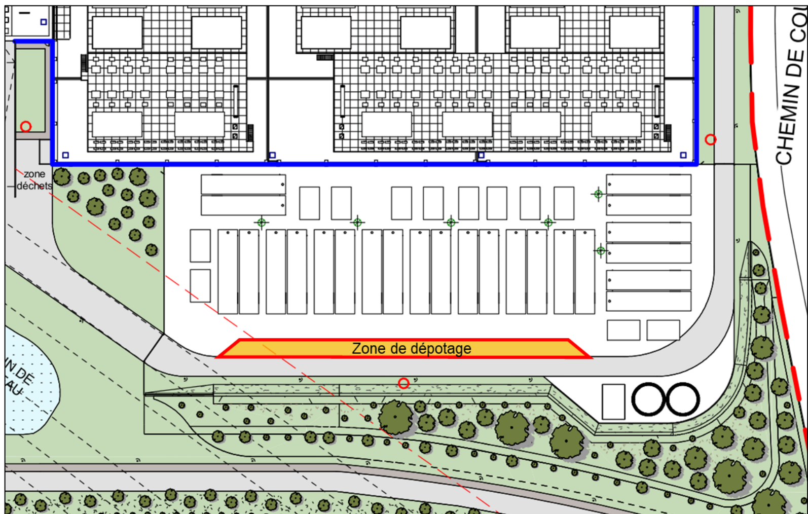
Figure 18 : Localisation des potentiels de danger en extérieure – Aire de dépôtage DC2
