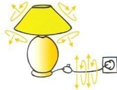
Le courant passe, le champ magnétique est présent avec le champ électrique
