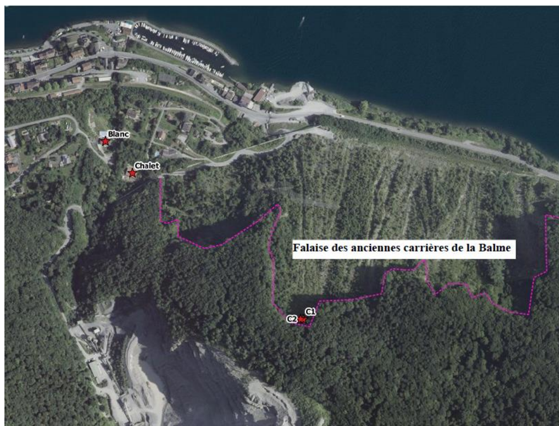
Carte 29 : Position des capteurs pour enregistrer les vibrations des tirs de mine (CEREMA, 2017)
