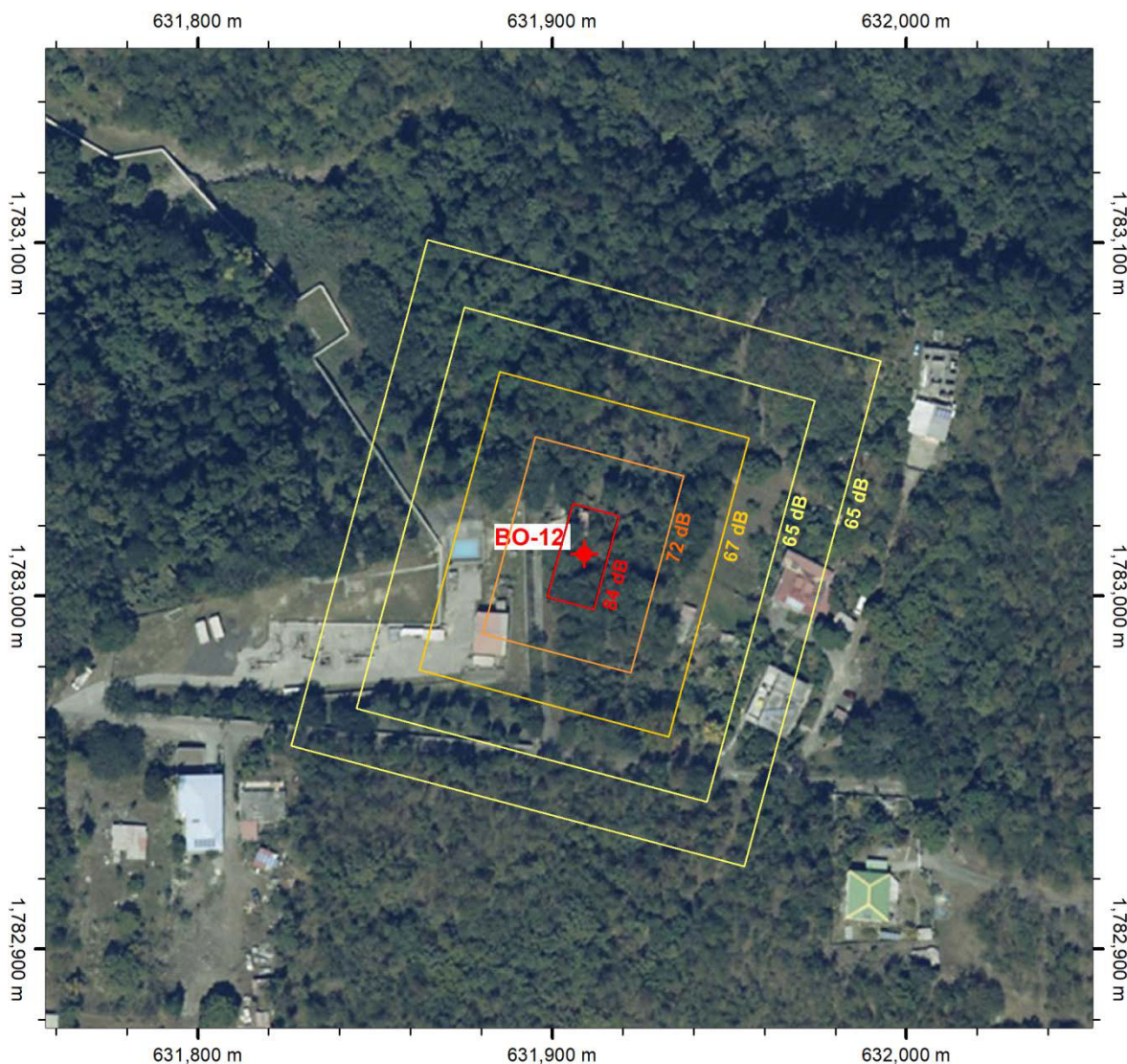
Figure 10 : Carte des niveaux de bruit générés par l'appareil de forage autour du site de forage des puits BO-12 (source : ORMAT).
